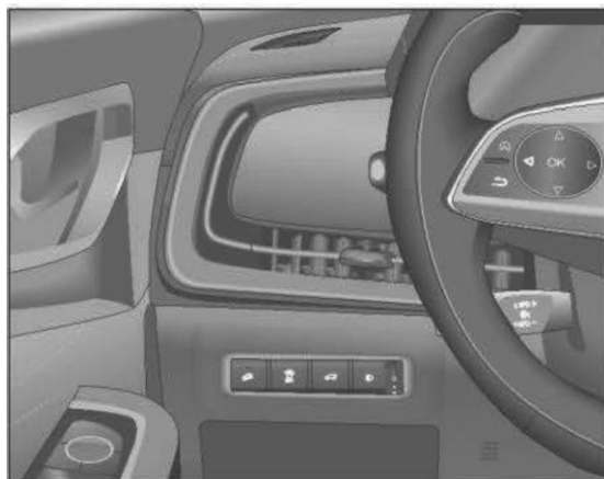
Levý ventilační otvor
